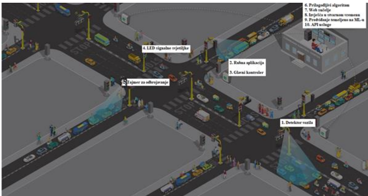
Slika 15. Elementi adaptivnog sustava semaforiziranih raskrižja
