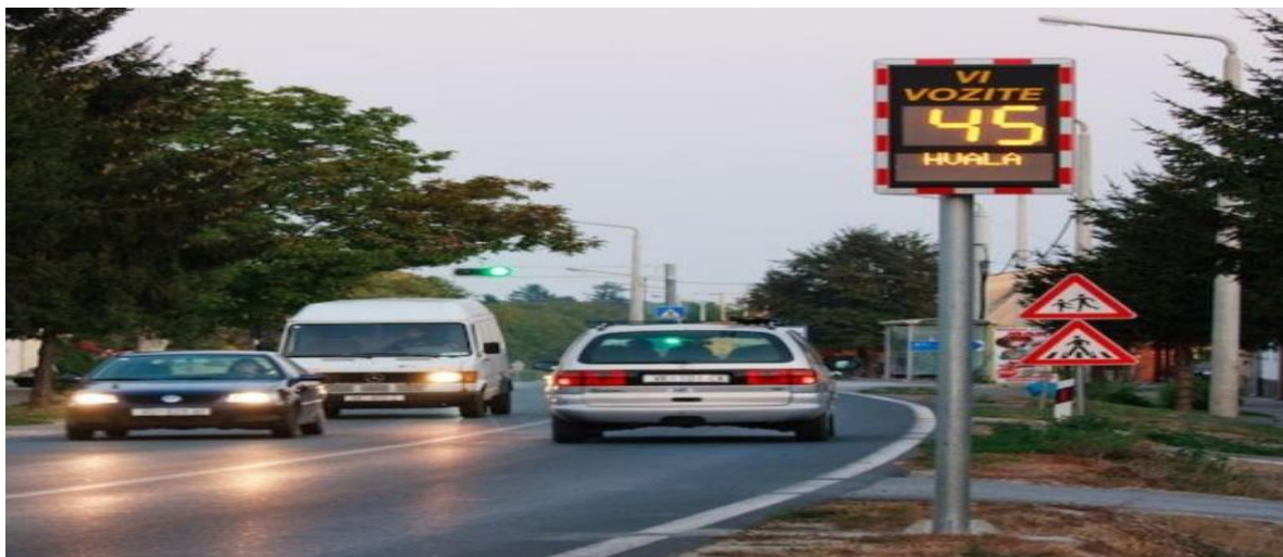
Slika 25. Radar s pokazivačem brzine
