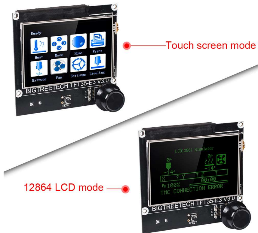
Slika 32. LCD ekran sa dva moda rada
