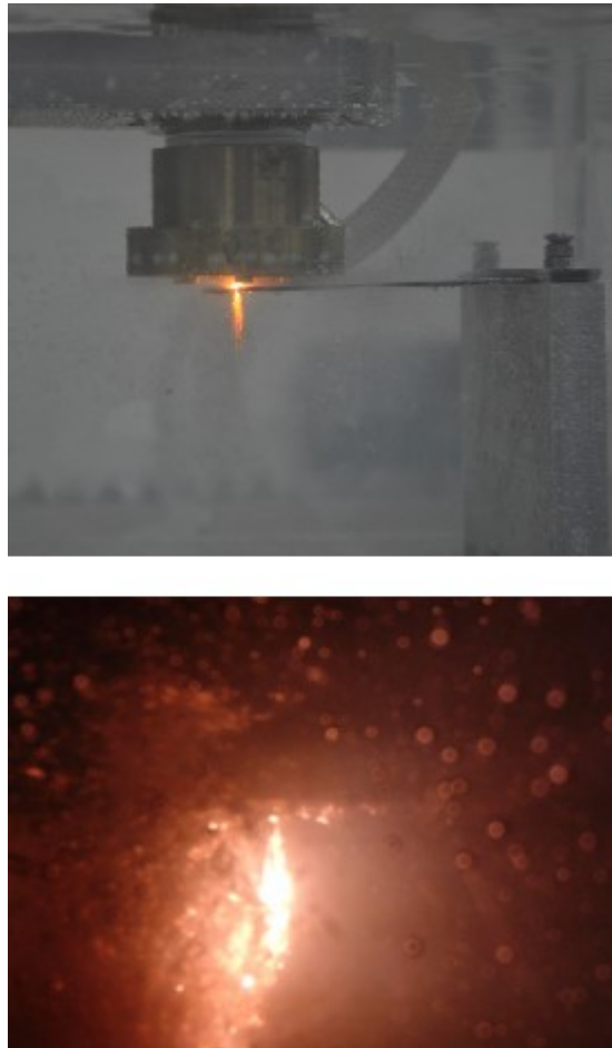
Slika 30. Prikaz usporedbe podvodnog rezanja nehrđajućeg čelika debljine 1 mm
