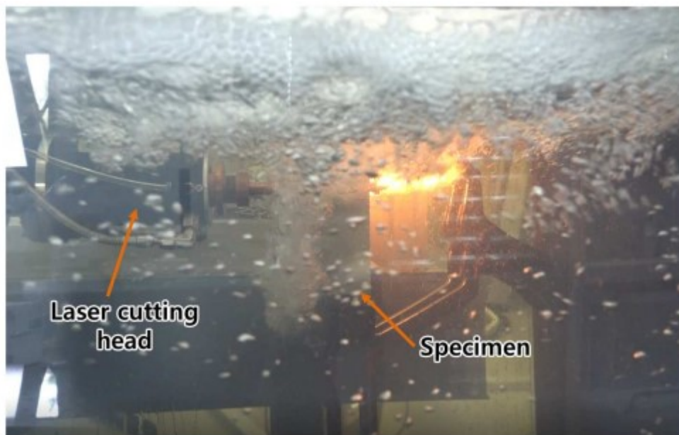
Slika 17. Prikaz procesa podvodnog rezanja laserom
