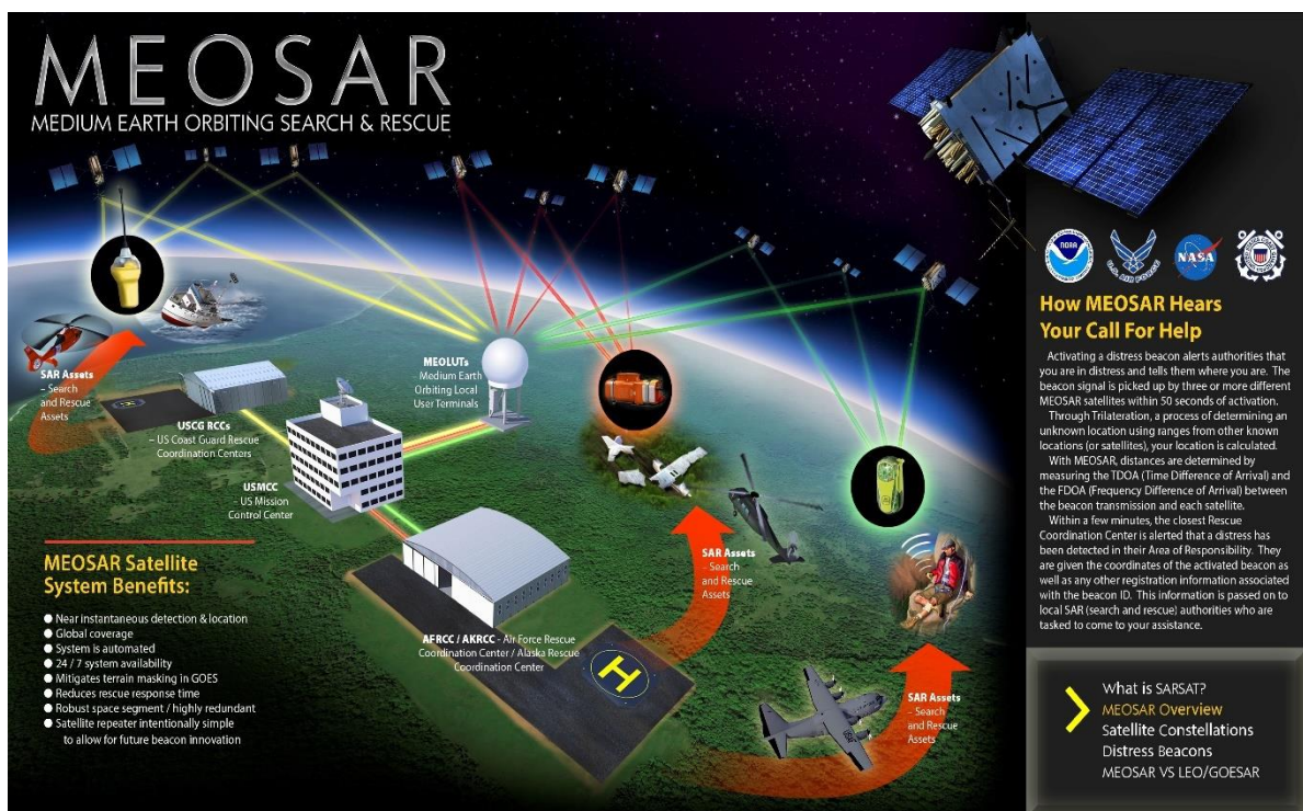
Slika 10: shematski prikaz rada i komunikacije MEOSAR sustava satelita
