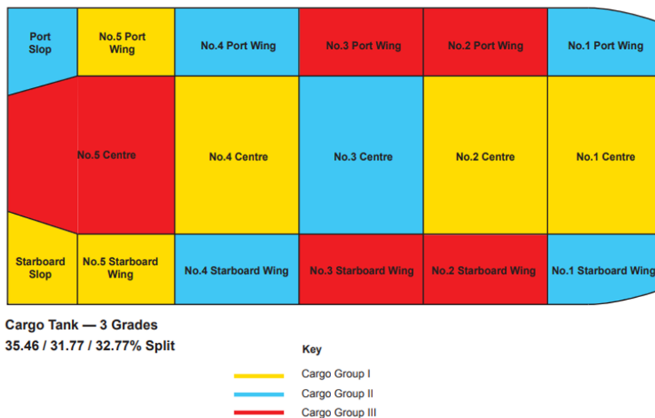
Slika 3. Raspored tankova na VLCC Ilma
