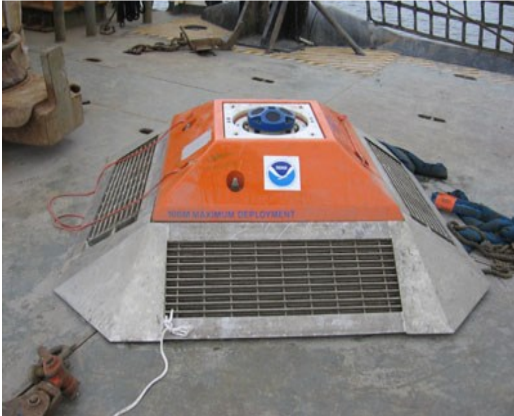
Slika 8. Izgled instrumenta koji radi na Dopplerov efekt [13].
