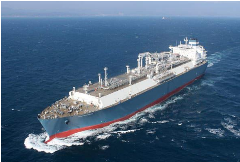
Slika 17:FSRU Independence, namjensko izgrađen FSRU brod
