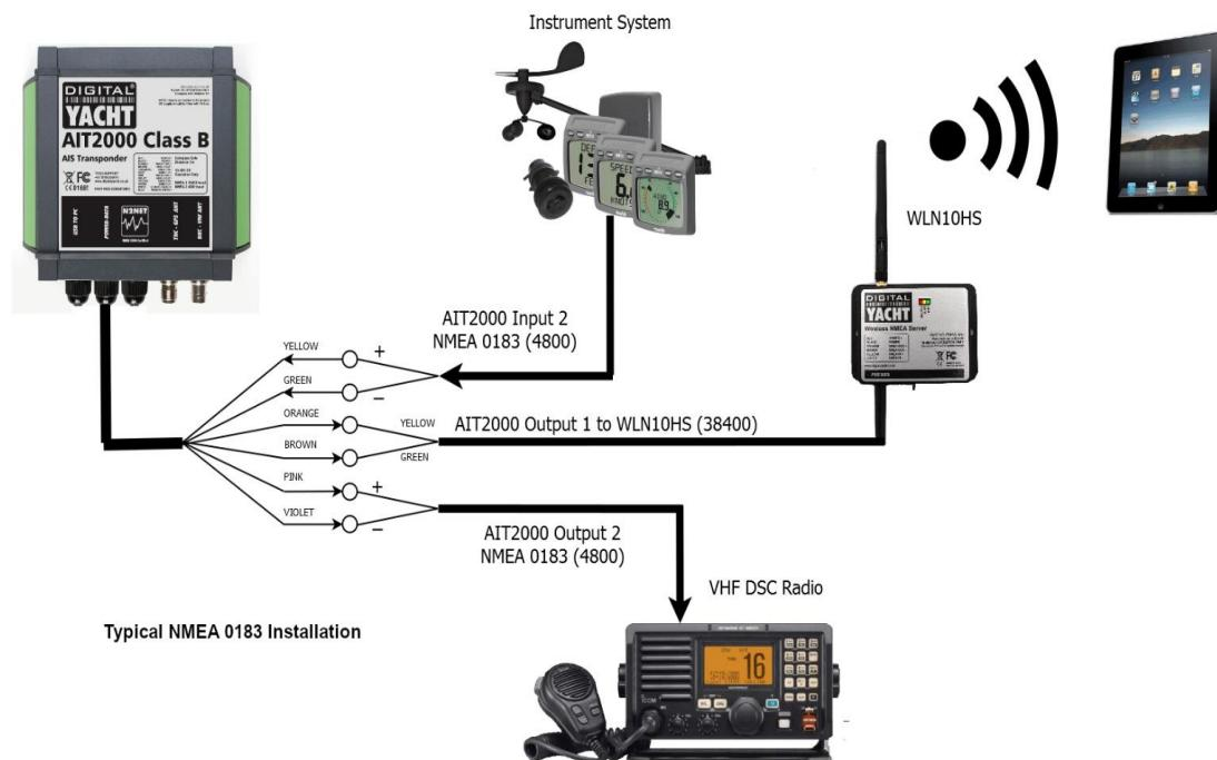
**Slika 27. Primjer povezivanja uređaja primjenom NMEA 0183**
