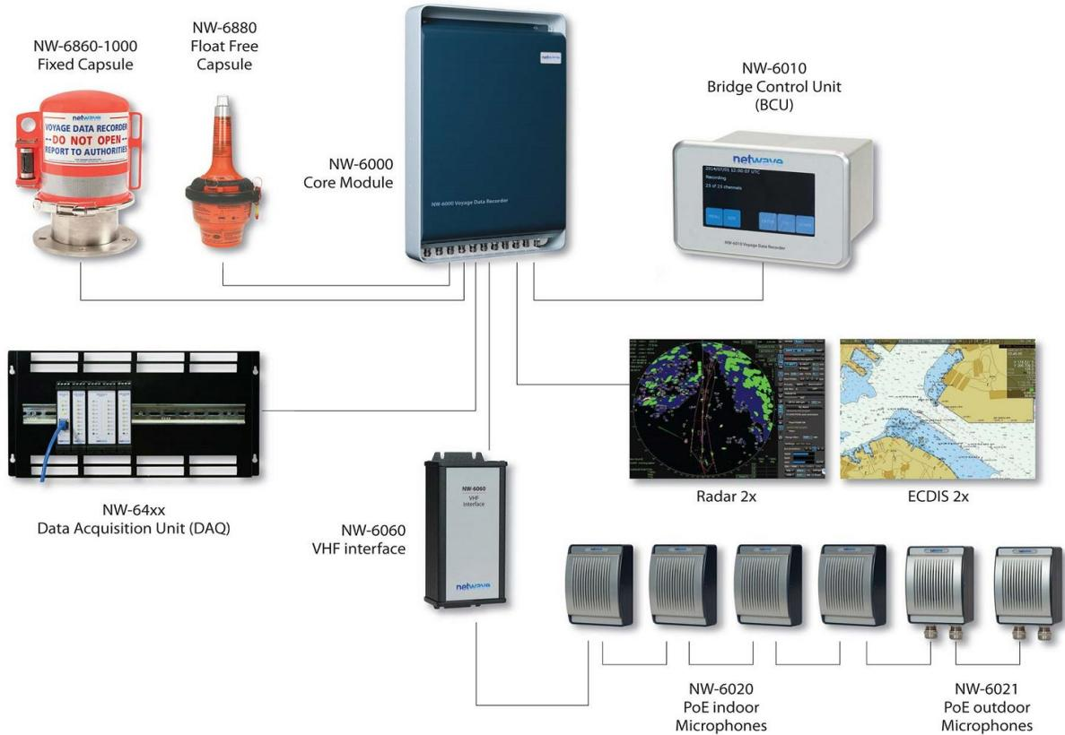
**Slika 21. Primjer VDR sustava u komunikacijskoj mreži TCP/IPv4**
