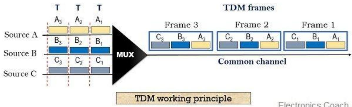
Slika 12. Princip rada TDM protokola
