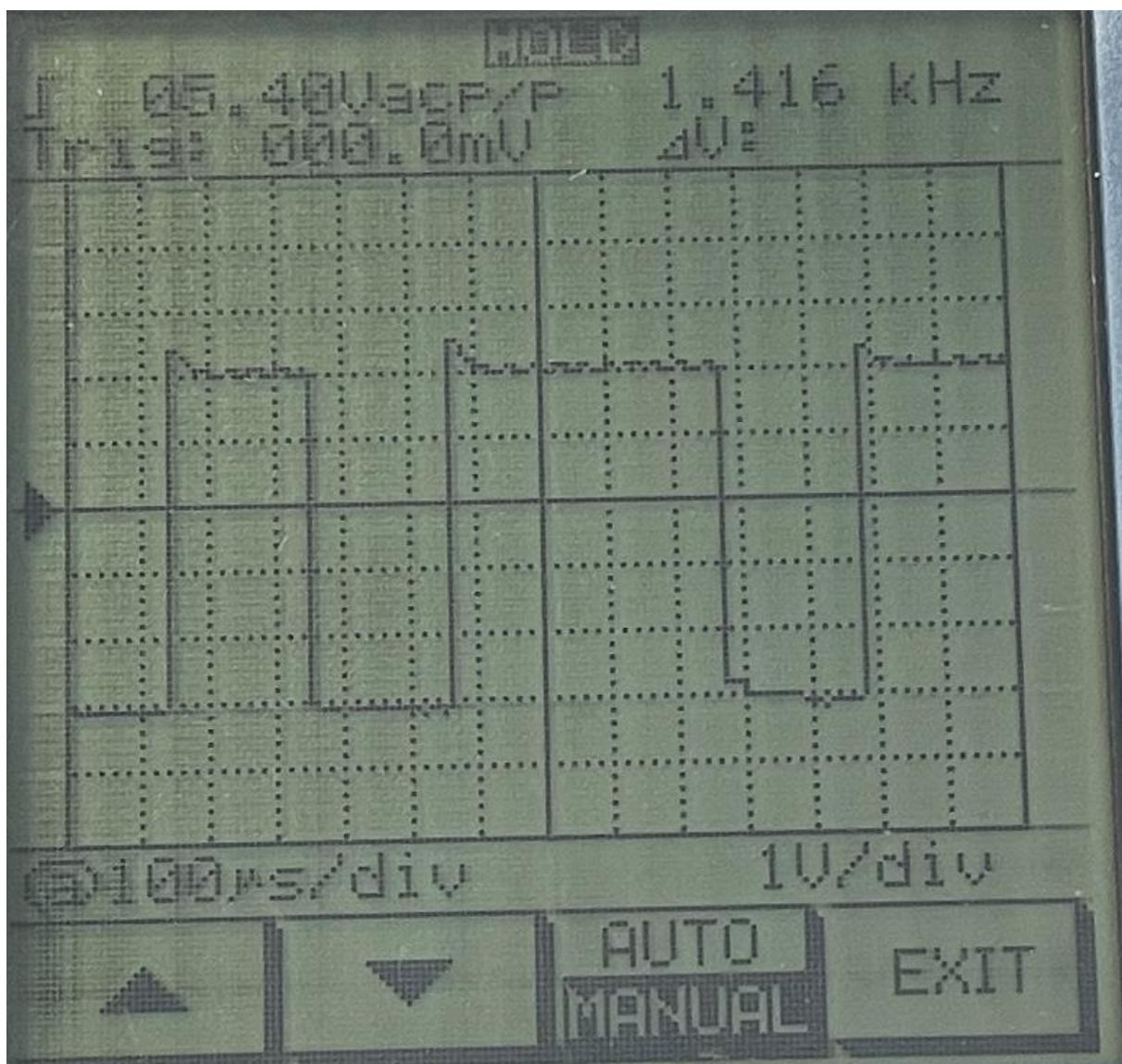
Slika 41. Ulagni parametri NMEA mreže bez spojenih prijemnih uređaja
