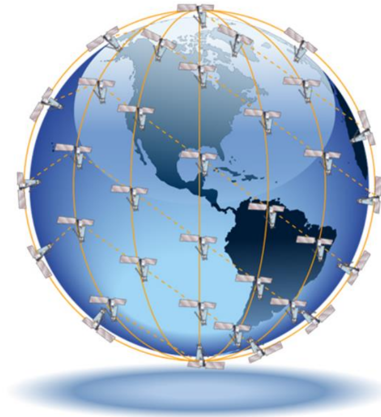
Slika 17. Smještaj i putanje Iridium satelita
