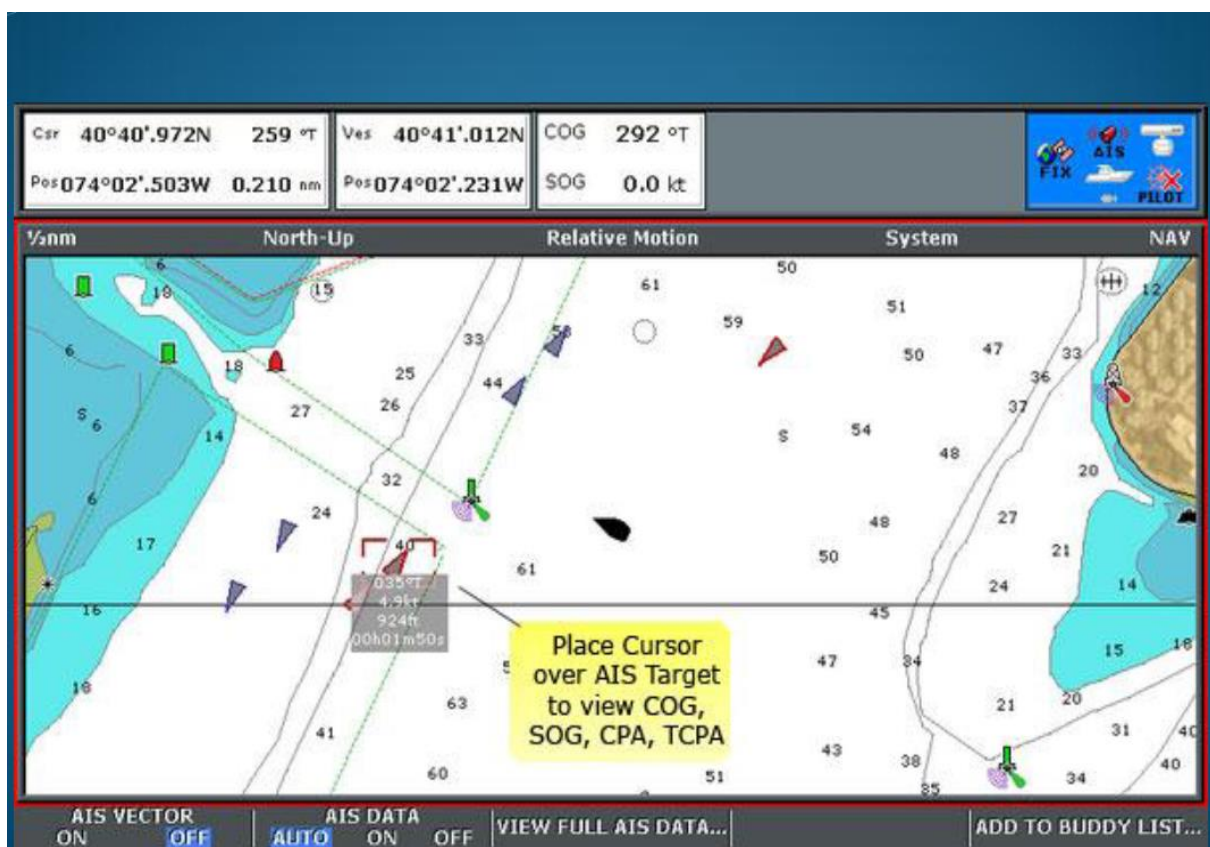
Slika 8. Prikaz navigacije uz pomoć AIS uređaja
