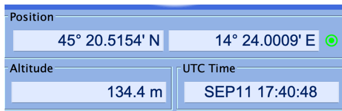
Slika 40. Prikaz pozicije sa GPS antene SCU-31
