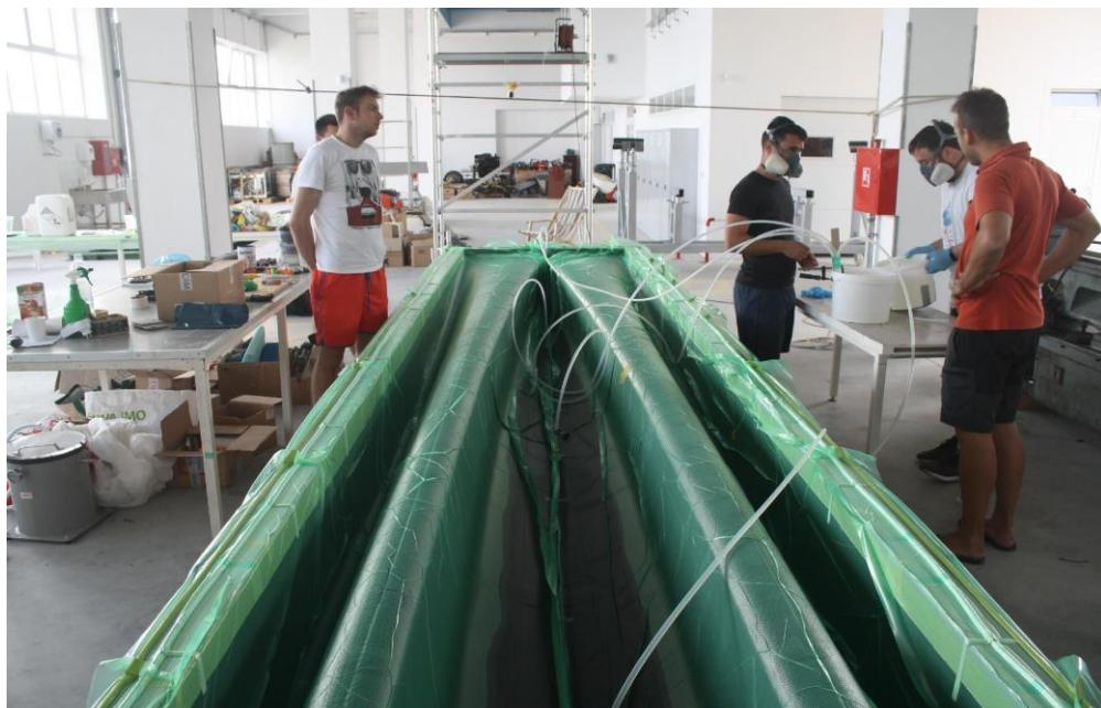
Slika 10 - Primjer gradnje plovila vakuumskom infuzijom u kalupu
