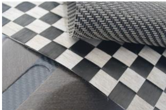
Slika 6 - Hibridna vlakna karbon-lan[5]
