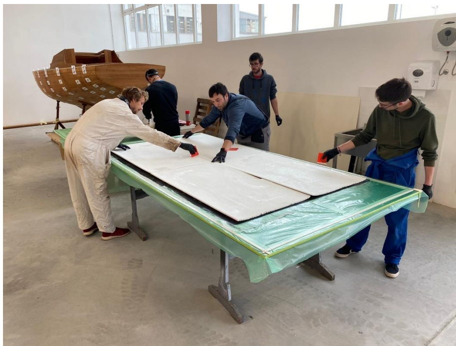
Slika 9 Prikaz procesa vacuum bagging-a
