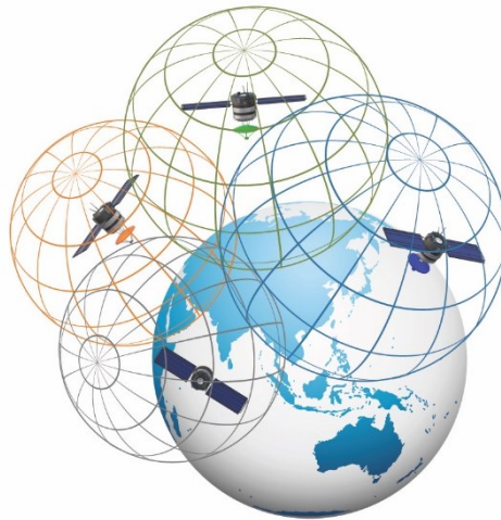
Slika 2.2.: Sjecište sfera određuje položaj GNSS-ovih prijavnika
