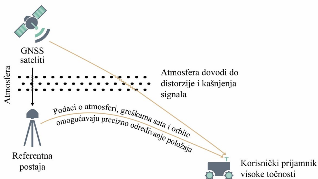
Slika 2.1.: Određivanje korisničkog položaja upotrebom referentnih zemaljskih postaja [53]
