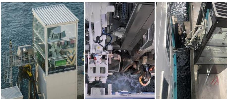
*Slika 28: Automatsko sučelje sustava kopnenog priključka temeljeno na ABB IRB7600 robotskoj ruci na ro-ro putničkom brodu „Tycho Brahe“; Kopneni dio sučelja (lijevo); Povezivanje priključka robotskom rukom (sredina); Kopneni priključak spojen s brodskim dijelom sučelja (desno)*
