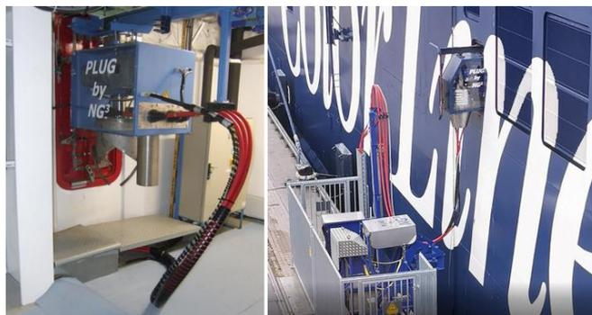
Slika 23: *NG3 PLUG* automatsko sučelje sustava kopnenog priključka na ro-ro putničkom brodu „MS Color Magic“; Brodski dio sučelja (lijevo); Kopneni dio sučelja (desno)
