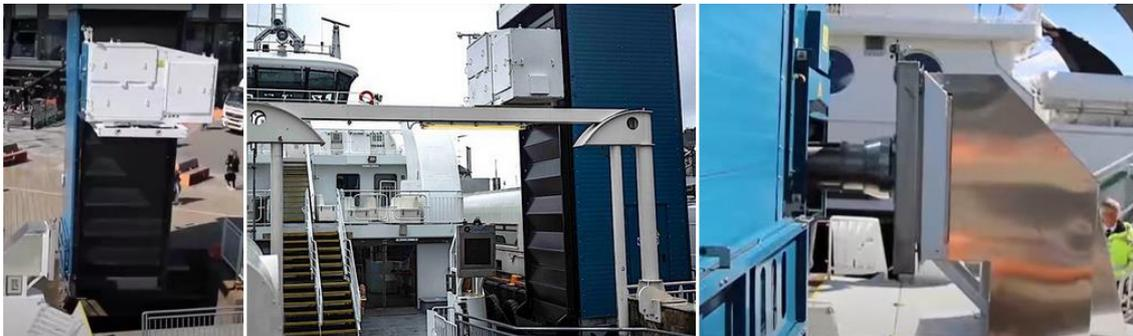
Slika 25: CAVOTEC APS horizontalno automatsko sučelje sustava kopnenog priključka na ro-ro putničkom brodu *Prinsen*; Kopneni dio sučelja (lijevo); Pozicija automatskog sučelja netom nakon pristanka (sredina); Spoj kopnenog i broskog dijela sučelja (desno)
