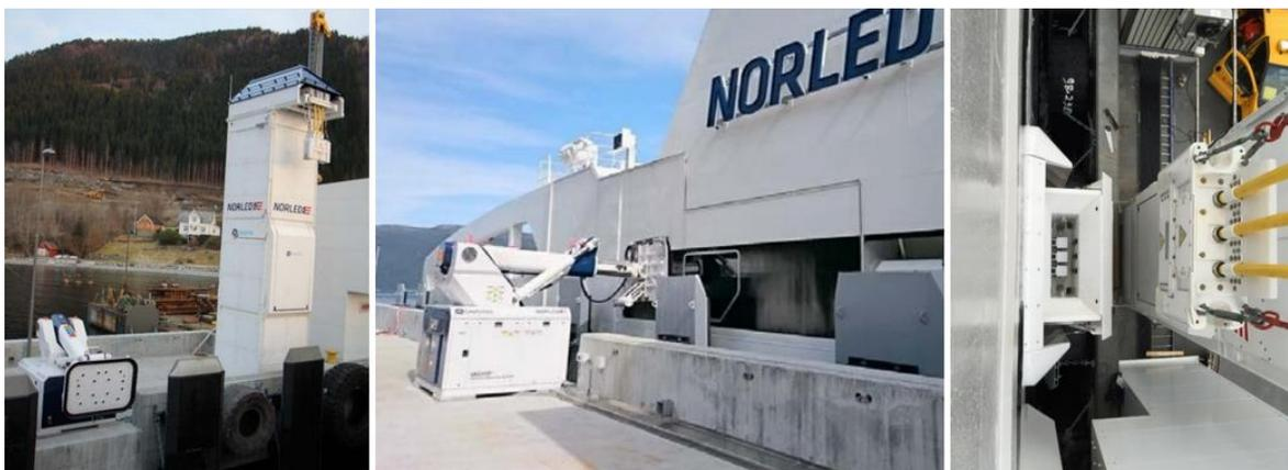
Slika 24: CAVOTEC APS vertikalno automatsko sučelje sustava kopnenog priključka na ro-ro putničkom brodu „Ampere“; Kopneni dio sučelja (lijevo); Vakuumski sustav za automatsko pristajanje (sredina); Brodski dio sučelja (desno)
