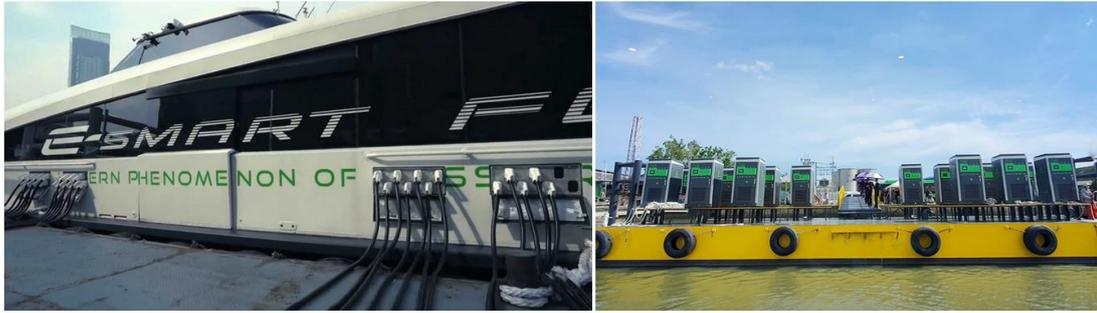
Slika 21: Ručni sustav povezivanja kopnenog priključka na ro-ro putničkom brodu „MINE Smart Ferry“; Energetski kabeli, utikači i utičnice (lijevo), sučelje kopnenog priključka (desno)
