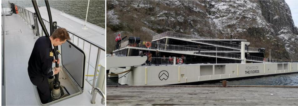
Slika 22: Ručni sustav povezivanja kopnenog priključka na turističkom putničkom brodu „Future of the Fjords“; Energetski kabele, utikači i utičnice (lijevo), kopneni priključak ugrađen u plutajući pristan (desno)
