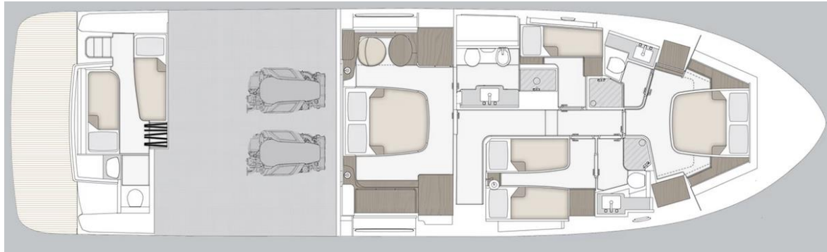
Slika 28: Tlocrt donje palube Azimuta 66
