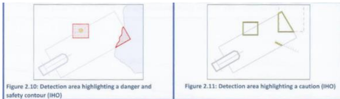
Slika 31. Slika lijevo: sigurnosni okvir opasnosti, slika desno: sigurnosni okvir otkriva moguće opasnosti
