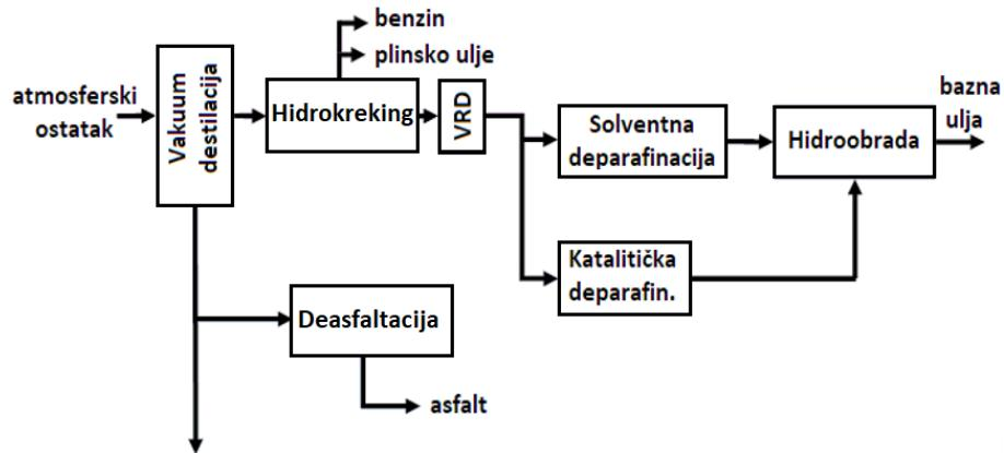
**Slika 10. Shema proizvodnje baznih ulja hidrokreking tehnologijom**
