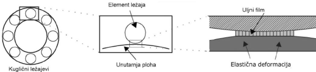
**Slika 3. Elastohidrodinamičko podmazivanje**
