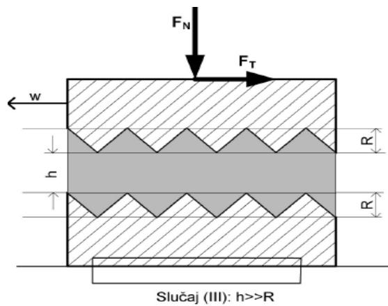
**Slika 4. Hidrodinamičko podmazivanje**
