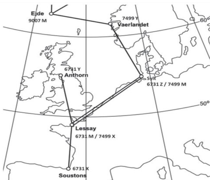
Slika 17. e-LORAN odašiljači u sjeverozapadnoj Europi
