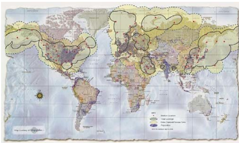
Slika 6. Područje pokrivenosti Loran-C sustava
