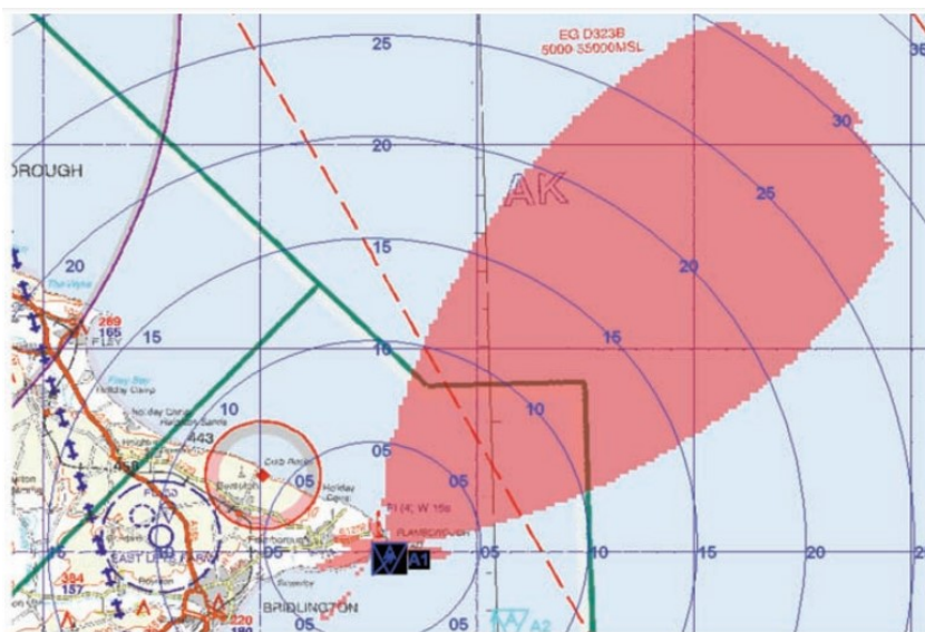
Slika 14. Područje pokrivenosti jedinice za ometanje GPS sustava na 25 m iznad razine tla pri maksimalnoj snazi od 1.58 W
