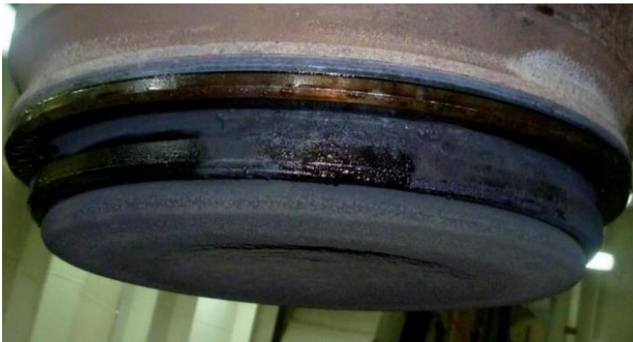
Slika 16. Ispušni ventil na motoru S60MC-C8.1 [11]
