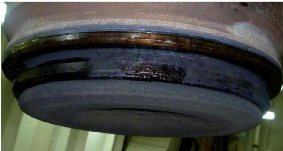
Slika 16. Ispušni ventil na motoru *S60MC-C8.1* [11]
