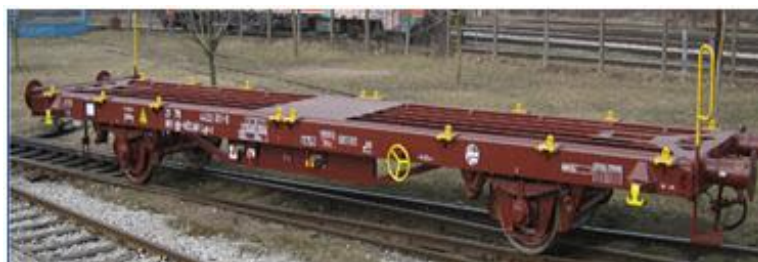
Slika 1. Specijalni plato vagon za prijevoz kontejnera
