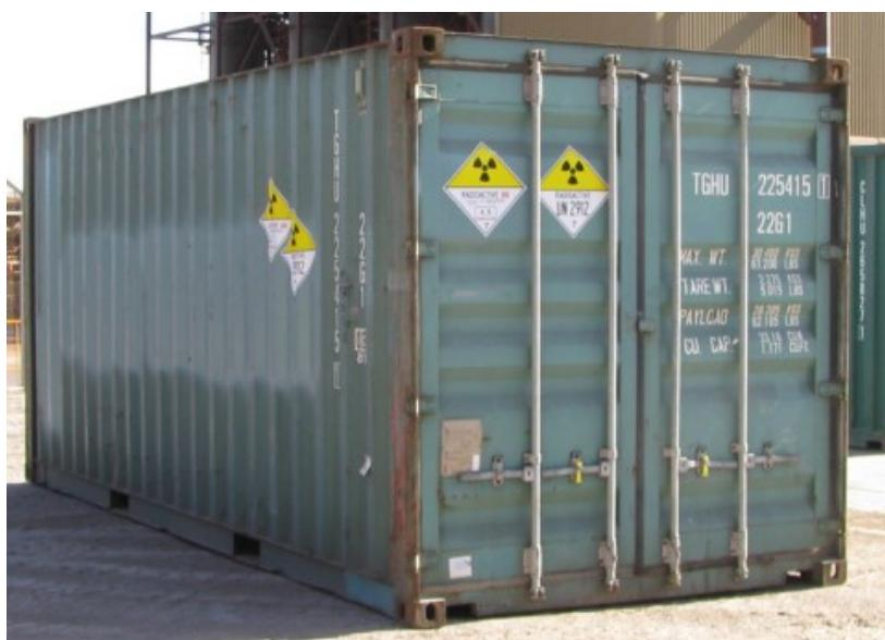
Slika 22: Kontejner za prijevoz radioaktivnog tereta [6]
