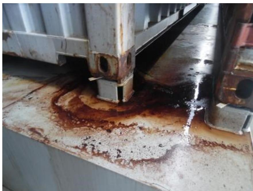
Slika 27: Izljev radioaktivnog tereta [18]
