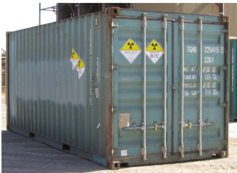
Slika 22: Kontejner za prijevoz radioaktivnog tereta [6]
