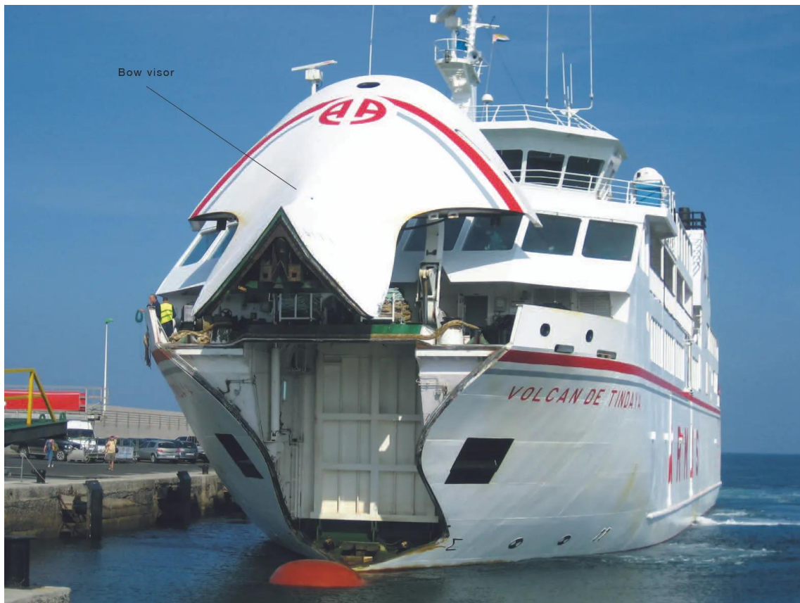
Slika 4. Pramčana aksijalna rampa
