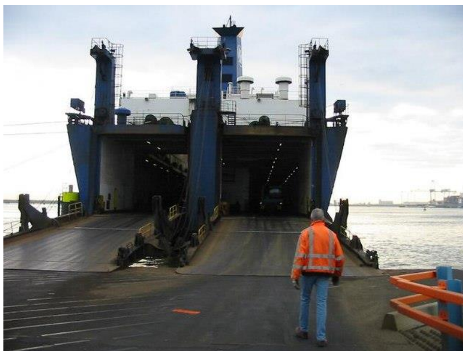
Slika 3. Krmena rampa sa odvojenim prometnim trakama
