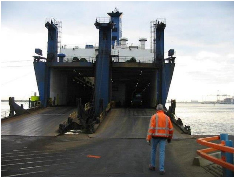
Slika 3. Krmena rampa sa odvojenim prometnim trakama
