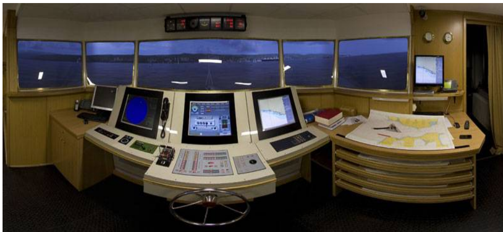
Slika 8 – Prikaz navigacijskog simulatora na Pomorskom fakultetu u Rijeci
