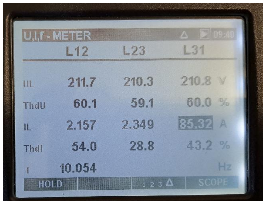
Slika 32: Mjerenje U, I, f kroz sve tri faze
