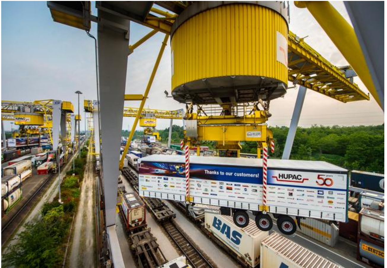
Fotografija 7. Prikaz prekrcaja na huckepack terminalu
