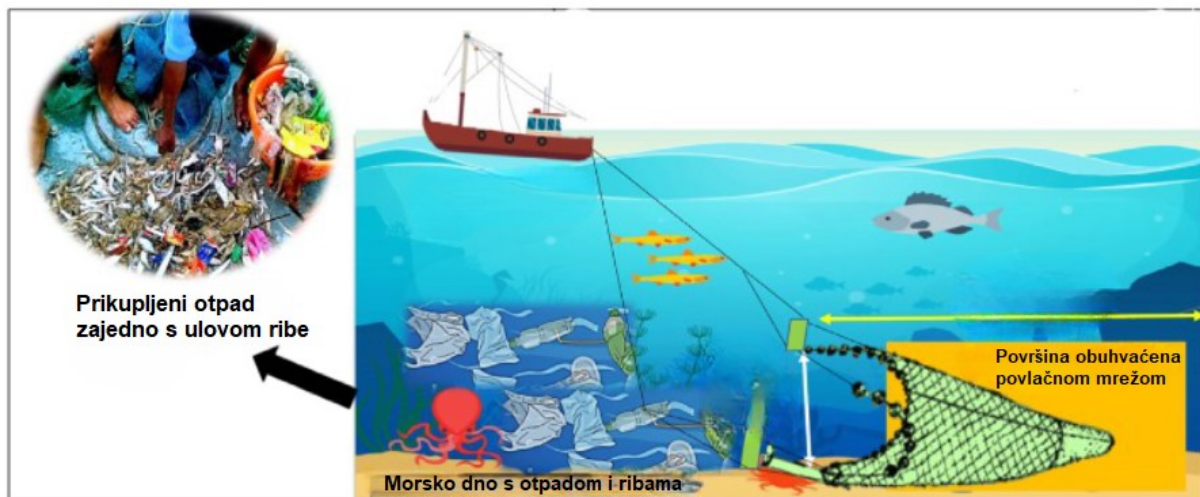
Slika 24. Ilustrirani princip rada povlačne mreže
