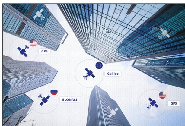
Slika 8. Primjer blokiranja signala satelita umjetnim tvorevinama
