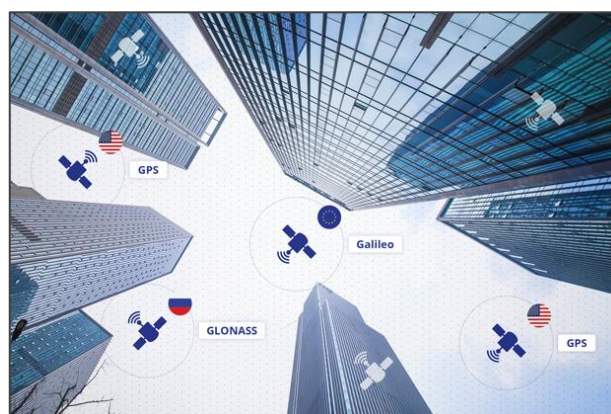
Slika 8. Primjer blokiranja signala satelita umjetnim tvorevinama
