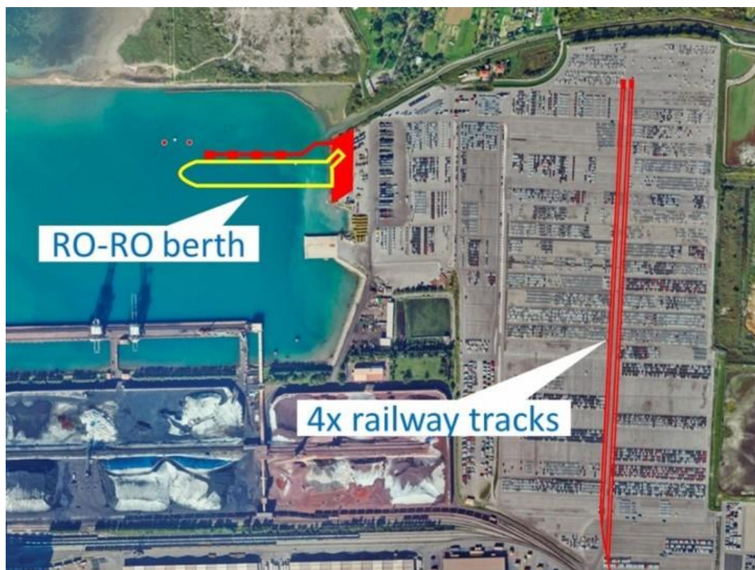
Slika 11. Izgled rasporeda RO-RO terminala u luci Kopar
