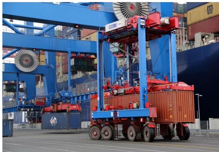
Slika 4. Portalni prijenosnik malog raspona
