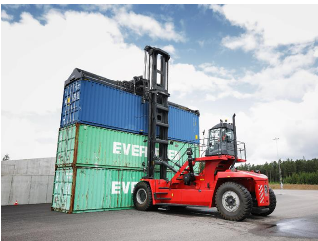
Slika 5. Čeoni hvatač kontejnera
