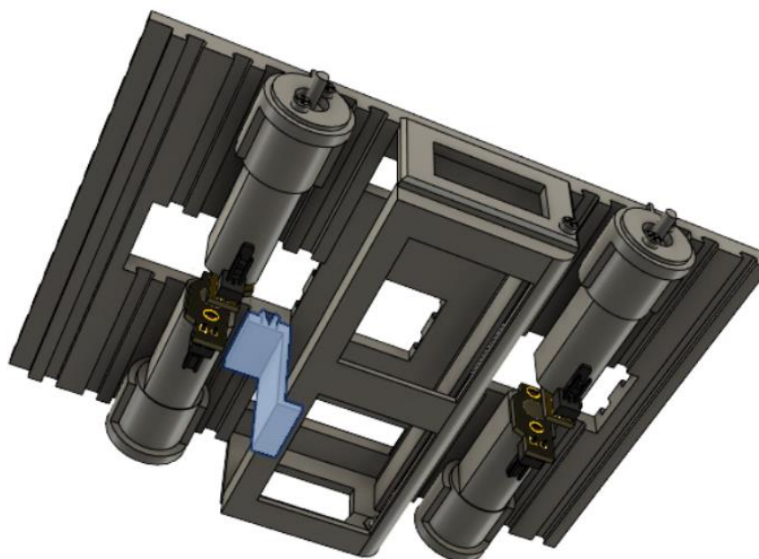
Slika 12. Prikaz kopče poklopca baterije [16]
