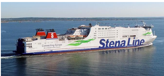
Slika 13: Prvi brod kojemu je ugrađen samostalan sustav metanola [13]
