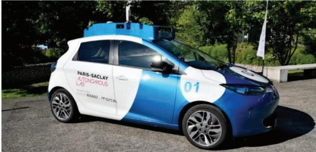
Slika 9. Primjer prototipa autonomnog vozila koji je razvila Grupa Renault za projekt EVAPS sa senzorom Velodyne UltraPuck LiDAR na vrhu
