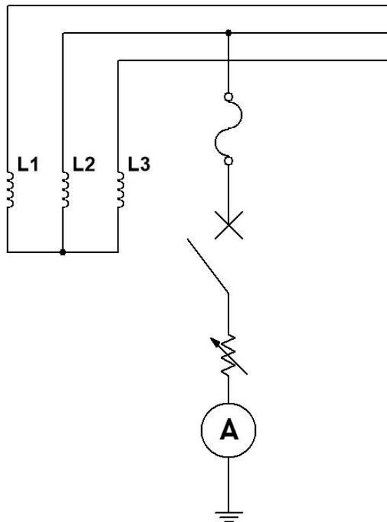
Slika 6. mjerjenje struje zemnog spoja
