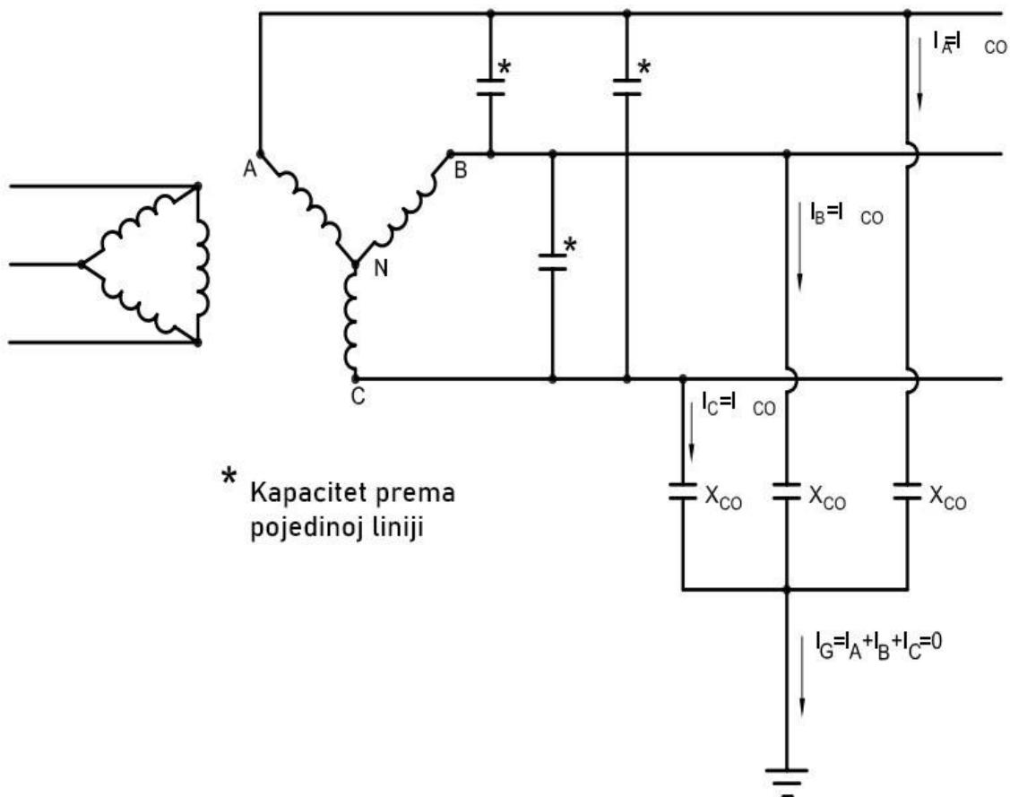
Slika 5. Neuzemljeni sustav te kapacitivna veza između pojedinih linija te mase
