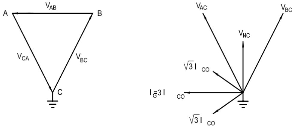
Slika 10. Vektorski prikaz sustava u zemnom spoju
