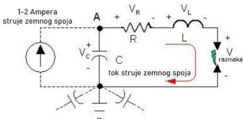
Slika 13. ekvivalentni prikaz toka struje zemnog spoja
