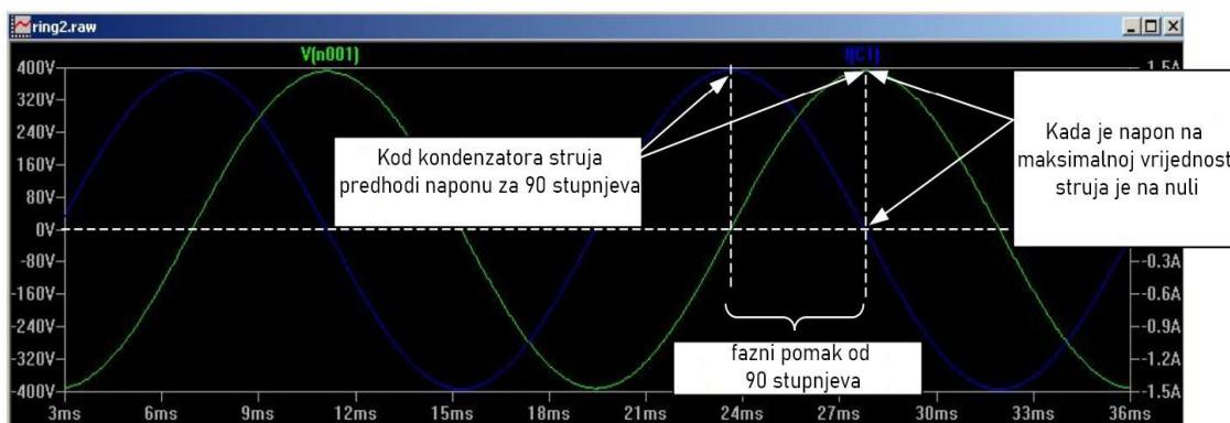
Slika 14. Odnos napona i struje kod čistog kapaciteta
