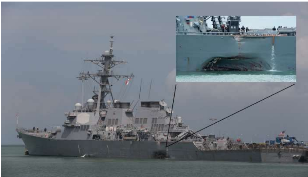
Slika 8. Šteta na USS John S. McCain
