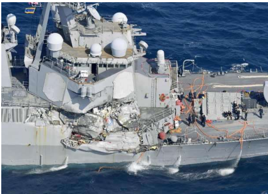
Slika 7. Šteta na USS Fitzgerald
