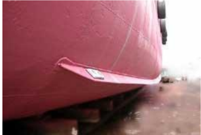
Slika 6. Shematski prikaz i slika ljuljne kobilice broda
