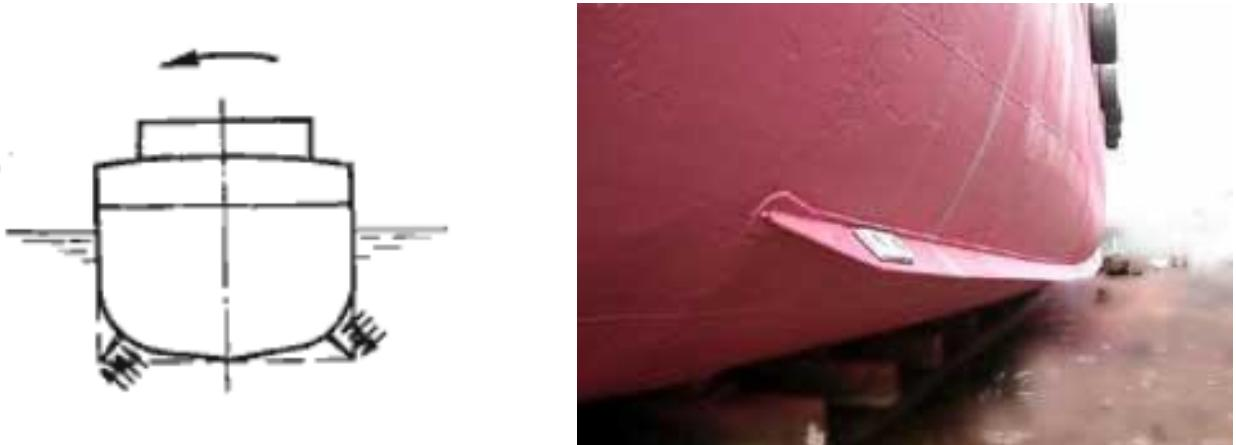
*Slika 6. Shematski prikaz i slika ljudjne kobilice broda*
