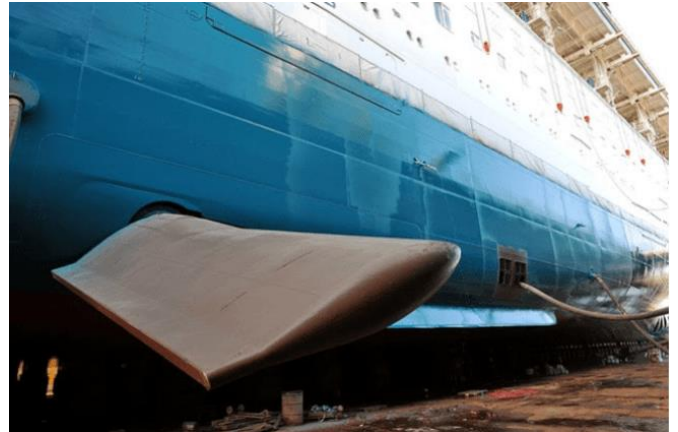
Slika 7. Shematski prikaz i slika krilnih stabilizatora gibanja
