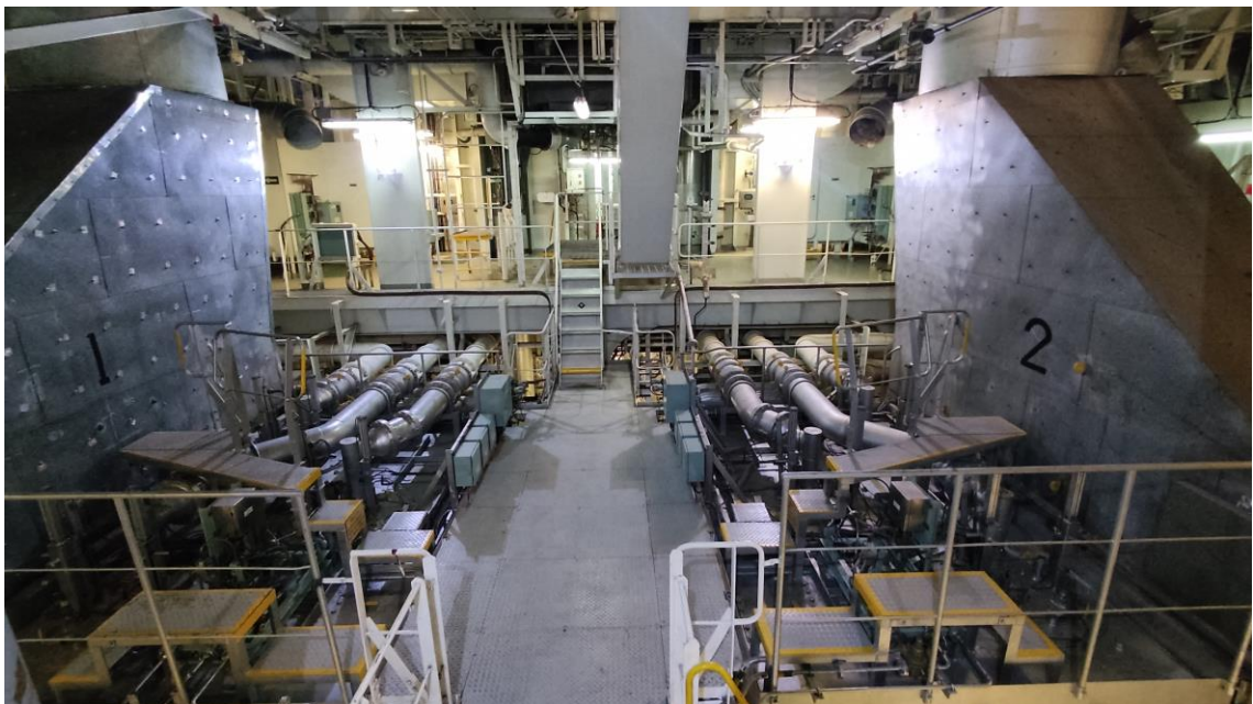
Slika 2: Prikaz oba generatora pare za ponovno uplinjavanje na brodu "Suez Neptune"[9]
