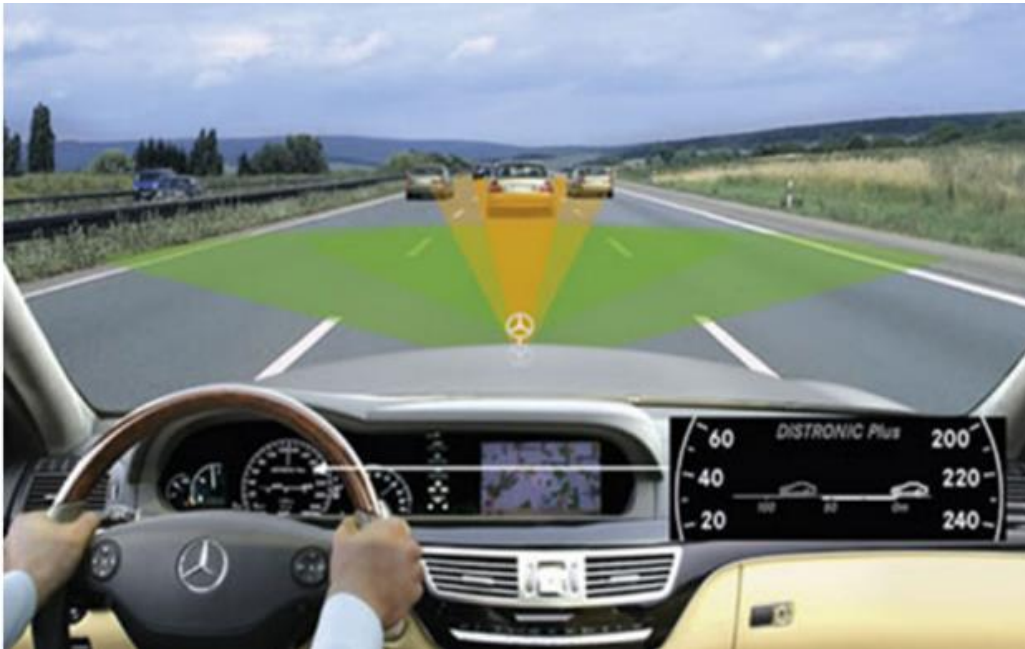
Slika 11. Primjer korištenja radara dugog i kratkog dometa
