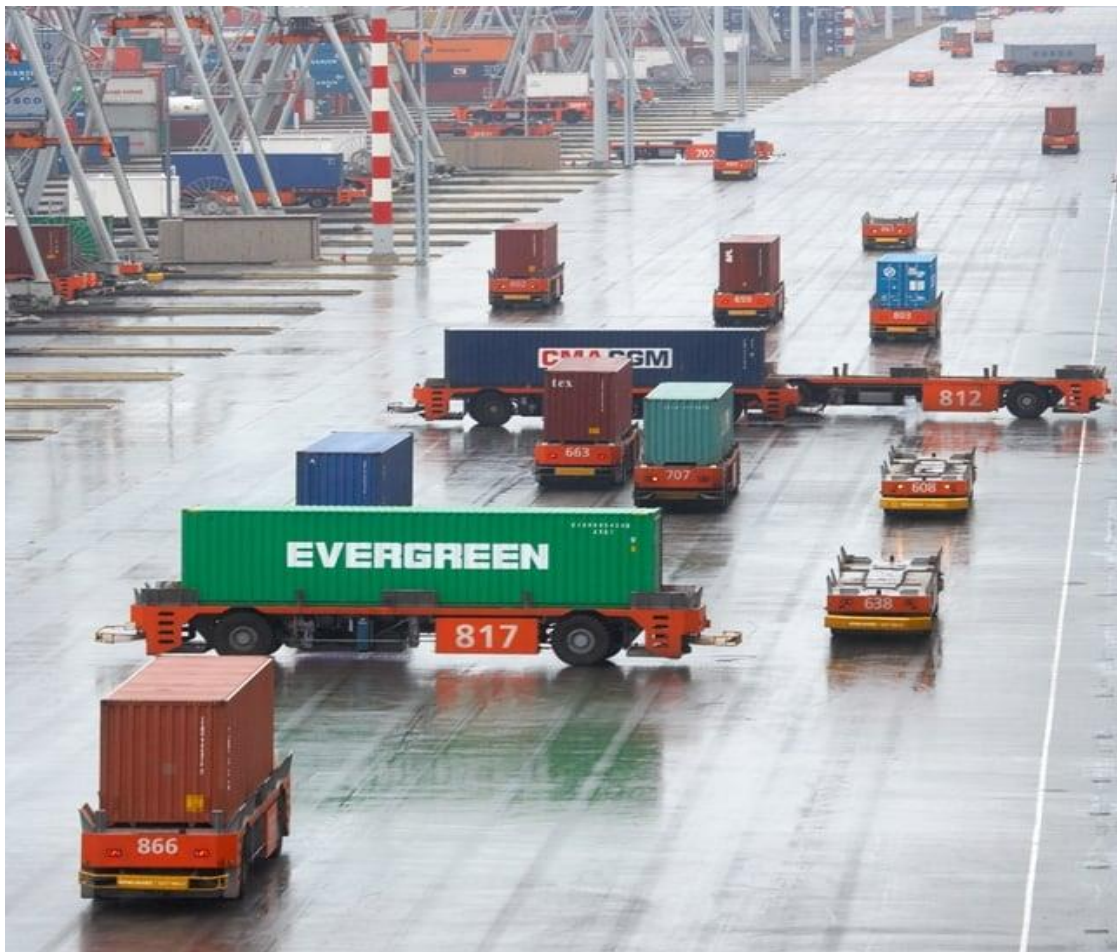
Slika 21. Primjer korištenja AGV-a na kontejnerskom terminalu
