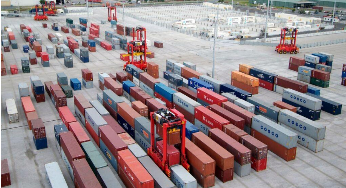
Slika 20. AutoStrad automatizirani kontejnerski prijenosnici
