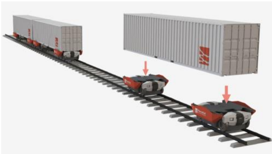
Slika 23. Prikaz Parallel System autonomnog željezničkog vozila
