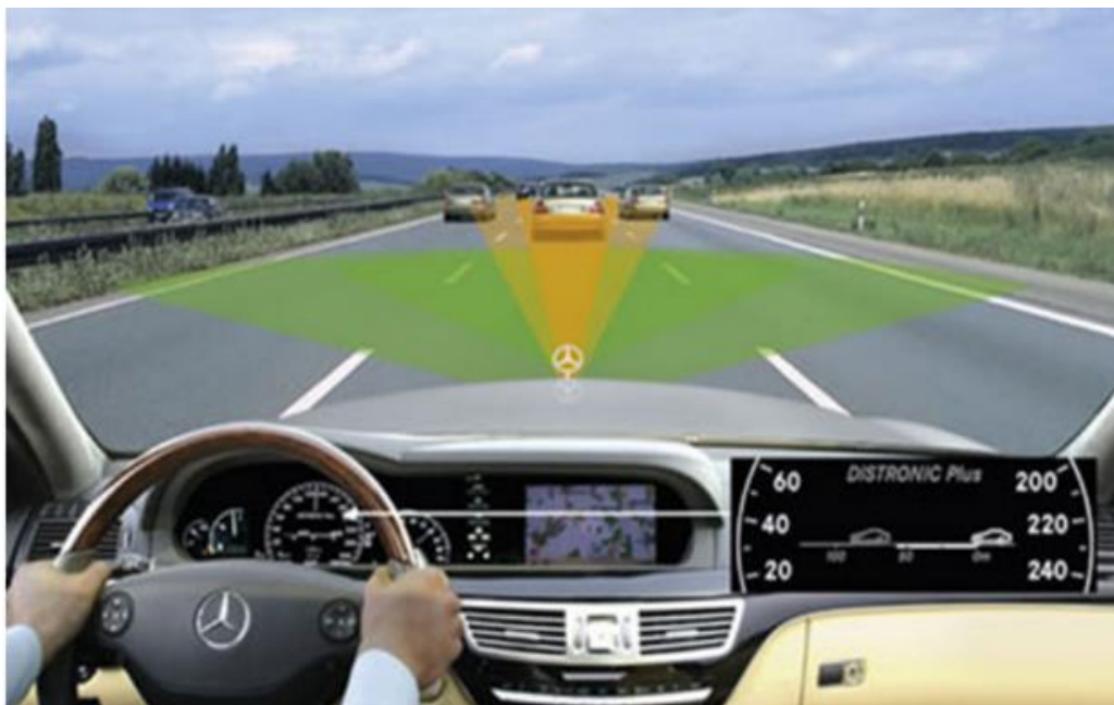
Slika 11. Primjer korištenja radara dugog i kratkog dometa
