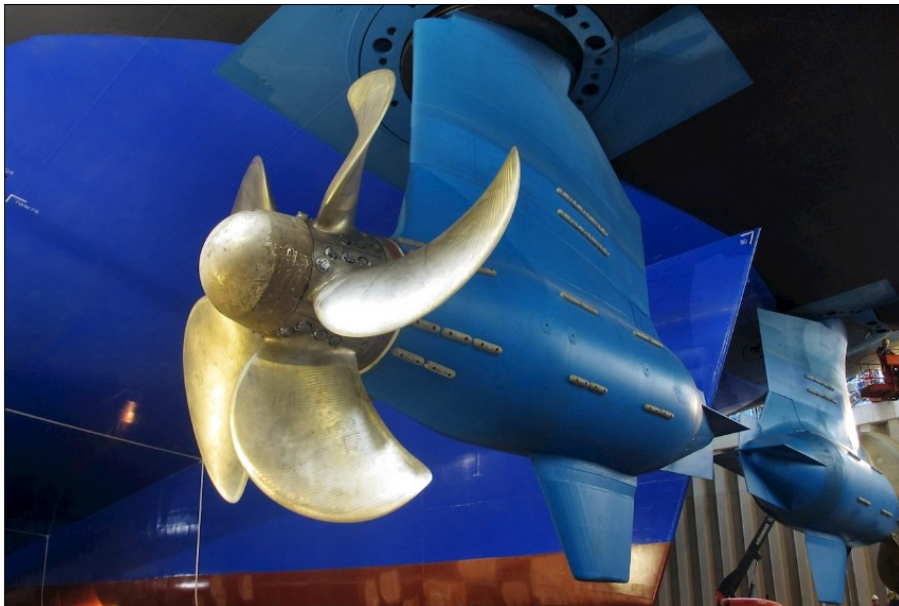
Slika 19. Vanjski izgled jedinice Azipod-a
