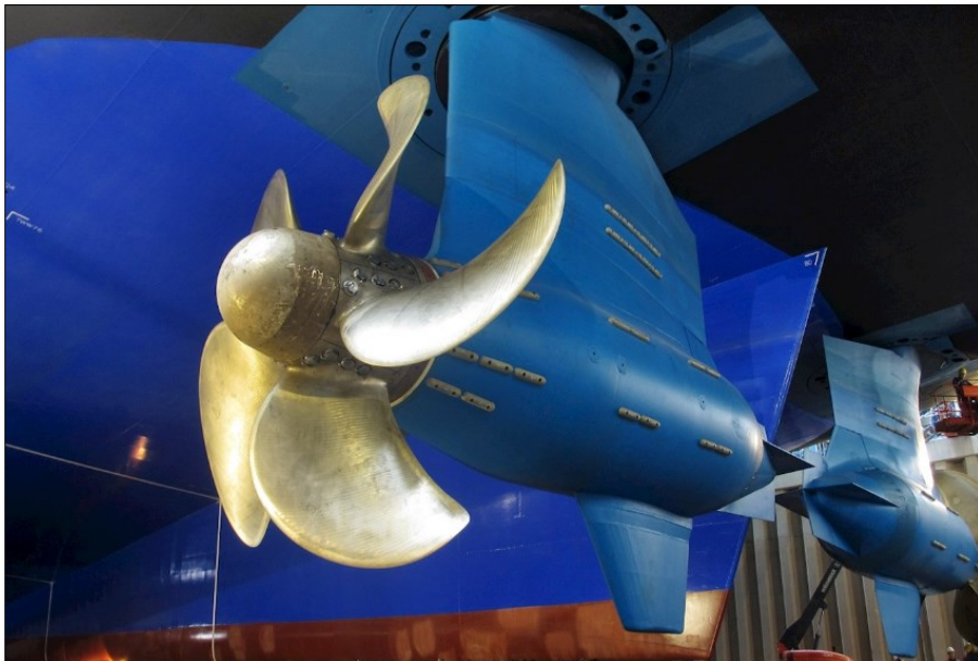
Slika 19. Vanjski izgled jedinice Azipod-a
