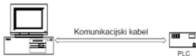
Slika 5. Shematski prikaz komunikacijskog sučelja PLC uređaja
