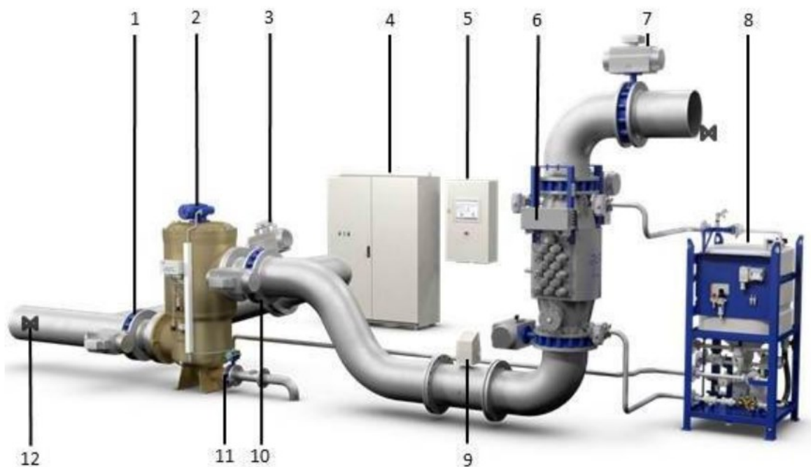
Slika 5. Komponente sustava Alfa Laval PureBallast 3.1 (1. Ulazni ventil filtera, 2.Filter, 3. Premosni ventil, 4. Lamp drive cabinet, 5. Upravljački ormar, 6. UV reaktor, 7.Kontrolni ventil, 8. Cleaning in place jedinica, 9. Mjerač protoka, 10. Izlazni ventil filtera, 11. Ventil povratnog ispiranja
