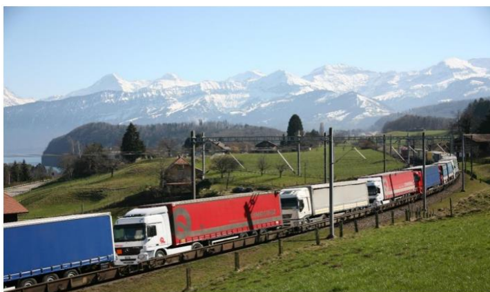
Slika 4. Huckepack tehnologija A
