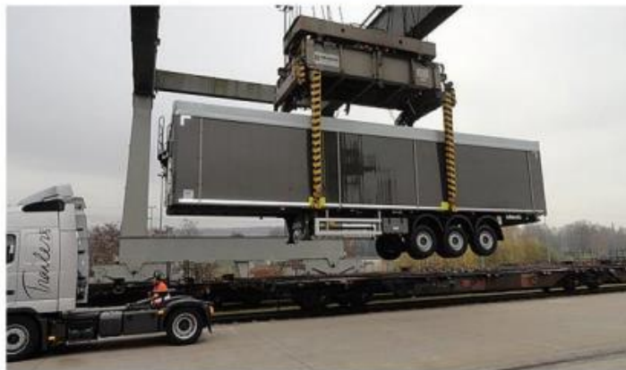
Slika 5. Huckepack tehnologija B
