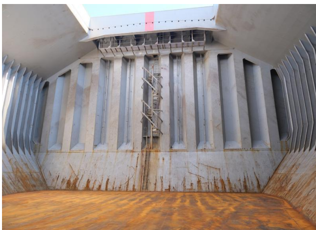
Slika 16: Unutrašnjost skladišta broda za rasuti teret
