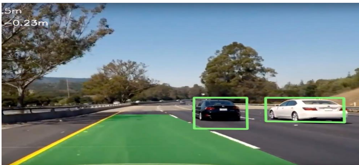
Slika 10. Prikaz detekcije prometne trake i vozila
