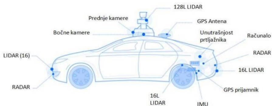
**Slika 2. Senzorski sustav autonomnog automobila**
