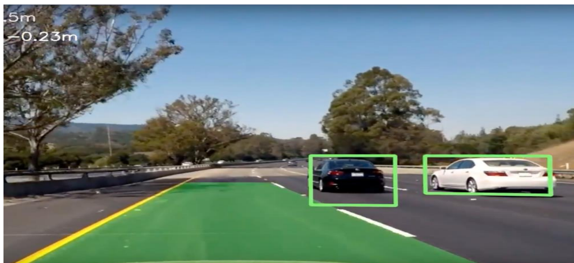
Slika 10. Prikaz detekcije prometne trake i vozila
