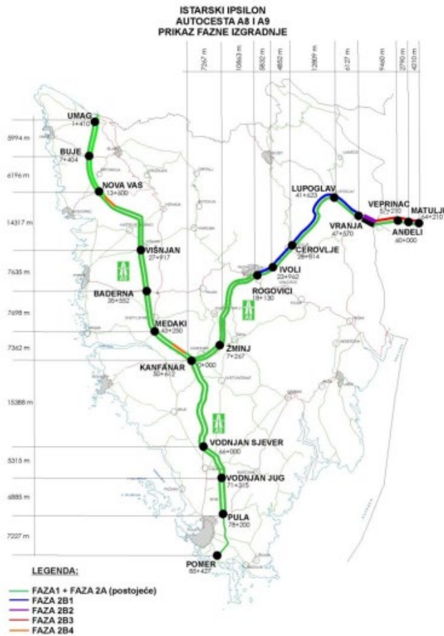
Slika 9 Pregled faza izgradnje Istarskog ipsilona
